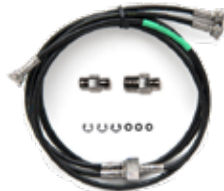
压力软管 40 bar / 600 psi 压力 T 形软管套件 1.5 m (5 ft)，带有 NPT 接头和密封件。软管所有端部都有 Bx G1/8" 内螺纹。
