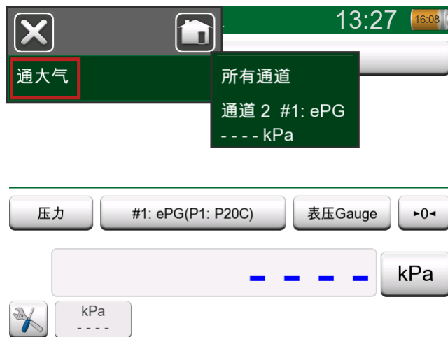
图 17: 泄压（Vent）菜单 - 校验仪模式
