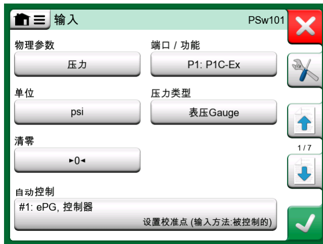
图 142: (适用于) 选择控制时的设备输入设置
