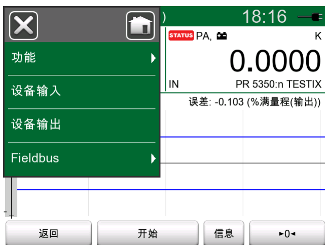
图 71: 校准 HART 设备时文档化校验仪中的菜单
