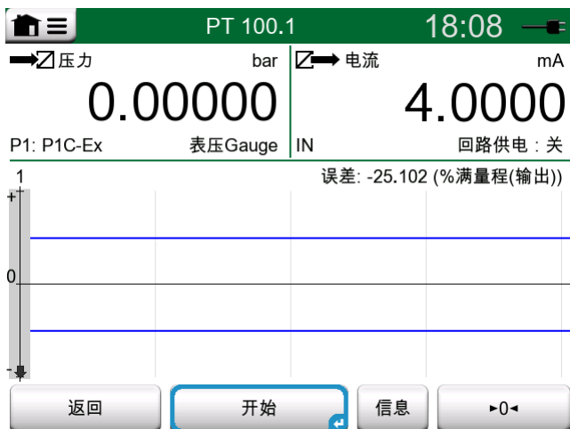
图 64: 右下角的压力模块归零按钮
