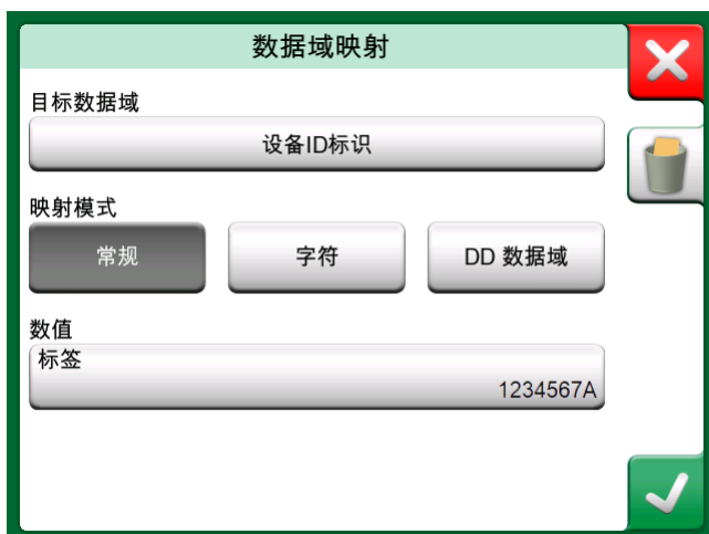
图 82: HART ® 协议默认映射示例
