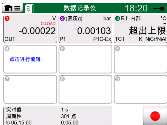
图 87：主配置窗口中的三个配置通道
