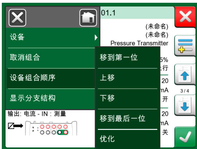
图 75: 对组合中的设备/功能进行排序
