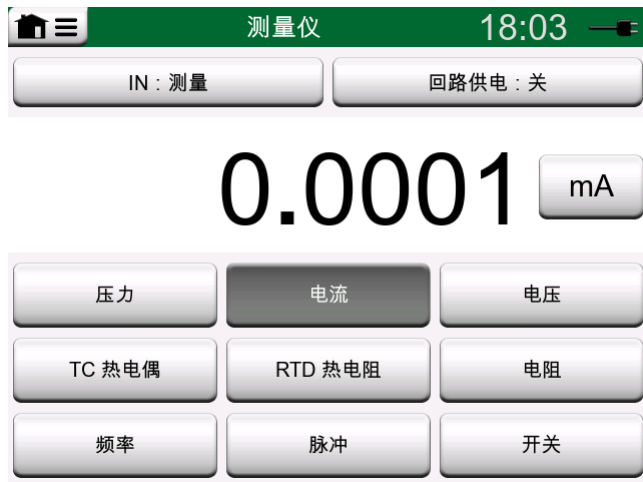
图 46：使用测量仪测量电流
